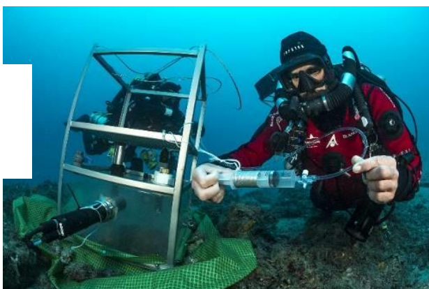
Thibault Rauby prélève de l'eau de la chambre benthique pour analyser son acidité (pH). ©Laurent Ballesta
