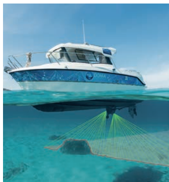
Acquisition de données bathymétriques à l'aide d'un sondeur multifaisceaux GeoSwath.
